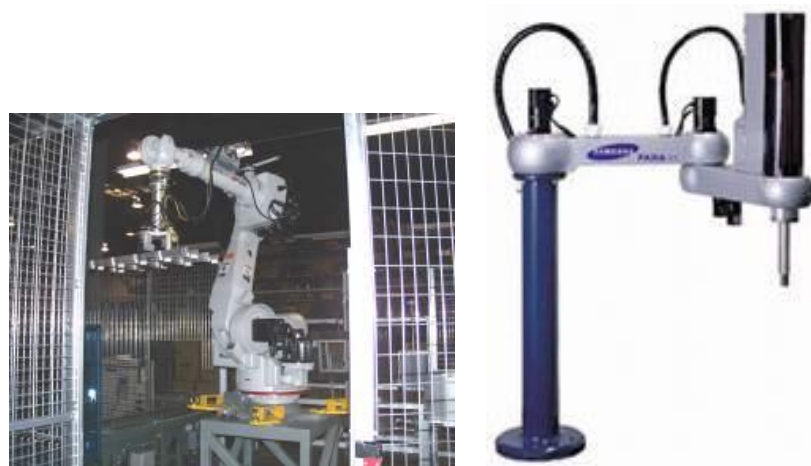
FIG. 2.1 – Bras manipulateurs de type anthropomorphe et SCARA
