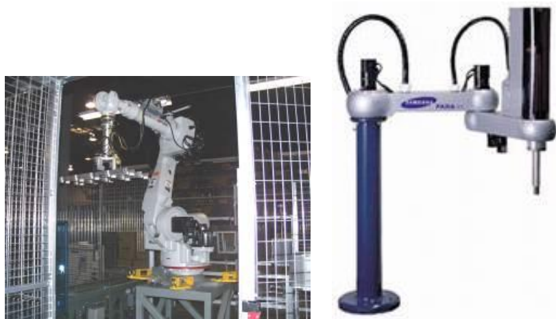
FIG. 2.1 – Bras manipulateurs de type anthropomorphe et SCARA
